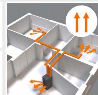
AIRBOX1 (optional): riscalda più ambienti, la stufa diventa ventilata e canalizzabile, radiocomando e filtro in dotazione
