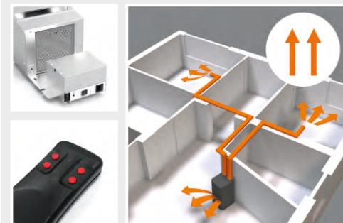
AIRBOX1 (optional): riscalda più ambienti, la stufa diventa ventilata e canalizzabile, radiocomando e filtro in dotazione
